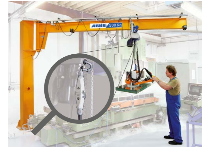
Grúa pluma con sistema de suspensión por vacío y enchufe (fig. 13)
