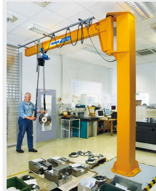
Ejemplo 4 Grúa pluma mural LWX con polipasto eléctrico de cadena ABUCompact GMC
