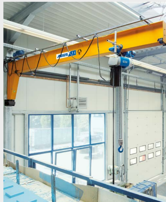
Ejemplo 6 Grúa pluma mural VW con polipasto eléctrico de cadena ABUCompact GM4
