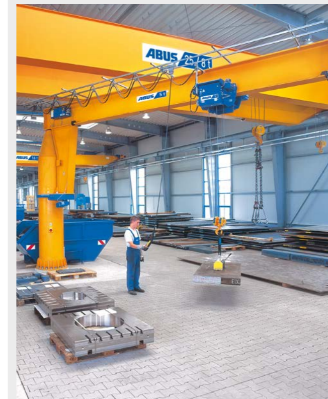
Ejemplo 8 Grúa pluma mural VW con polipasto eléctrico de cable GM 800
