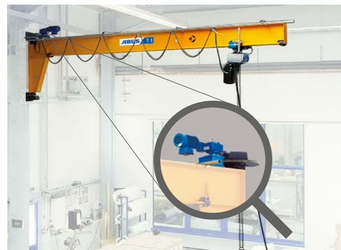
Giro eléctrico del brazo (fig. 3)
