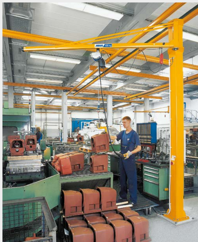
Ejemplo 2 Grúa pluma mural LW con polipasto eléctrico de cadena ABUCompact GM2
